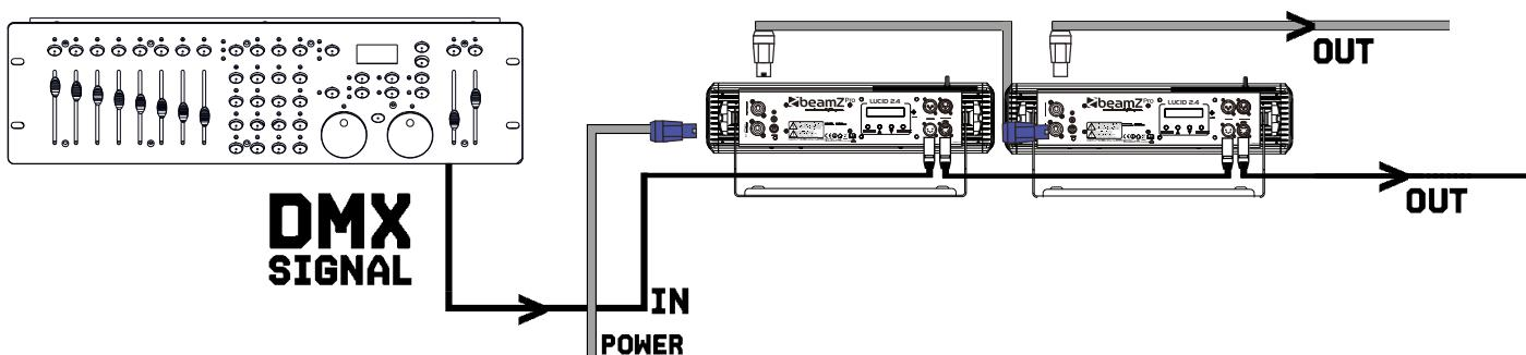
**ATENCIÓN!** En el último aparato, debe cerrar la línea DMX con una resistencia de terminación. Tome un conector XLR y suelde una resistencia de 120 Ohm entre la señal (-) y la señal (+) y conéctela a la salida DMX del último dispositivo en la línea.
