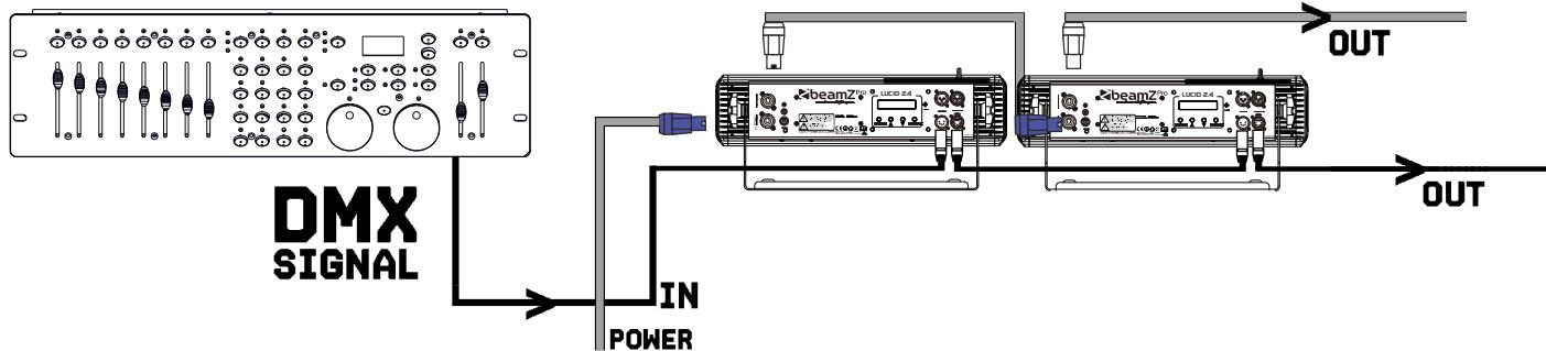
**ACHTUNG!** Bei der letzten Gerät müssen Sie die DMX-Leitung mit einem Abschlusswiderstand schließen. Nehmen Sie einen XLR-Stecker und löten Sie einen 120-0hm-Widerstand zwischen Signal (-) und Signal (+) und stecken Sie diesen in den DMX-Ausgang der letzten Gerät in der Leitung.
